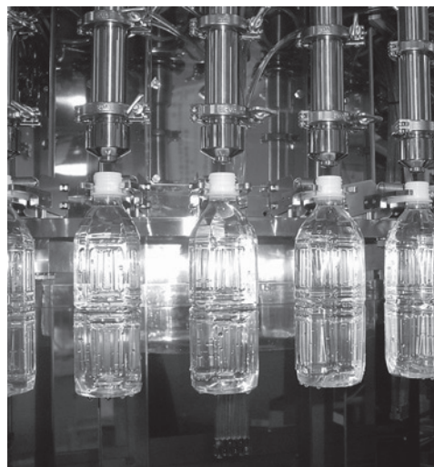
写真 1 容器に液体を充填する装置
