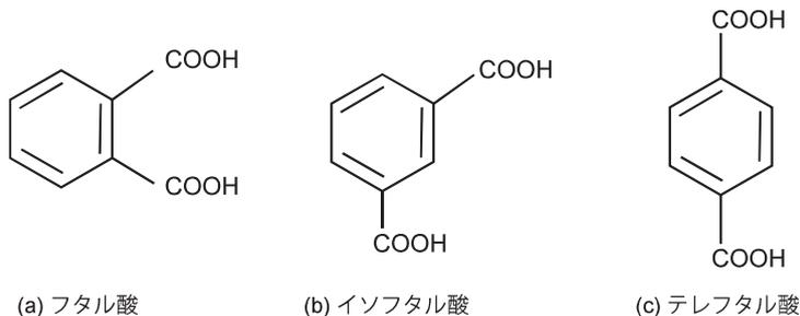
図表2 フタル酸、イソフタル酸、テレフタル酸の化学構造式
